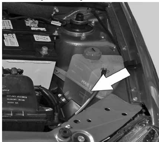
Рисунок 19 – Проверка уровня охлаждающей жидкости
