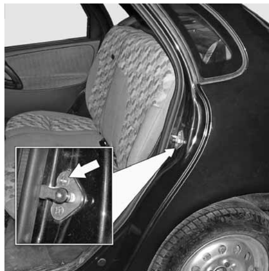
Рисунок 6 – Проверка работы замка задней двери
