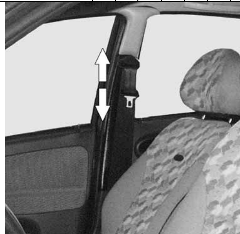
Рисунок 16 – Проверка работы регулятора высоты ремня безопасности
