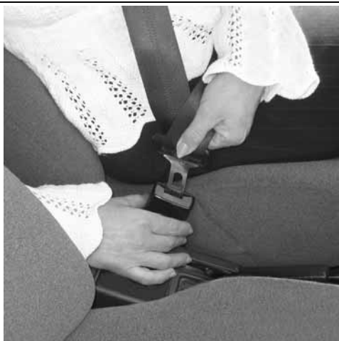
Рисунок 15 – Проверка работы замка ремня безопасности
