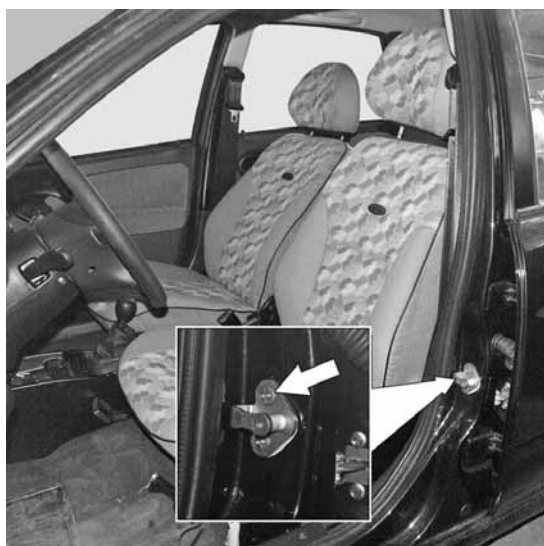
Рисунок 5 – Проверка работы замка передней двери
