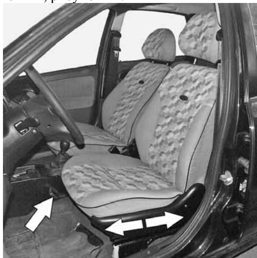
Рисунок 12 – Проверка работы механизма перемещения передних сидений в продольном направлении
